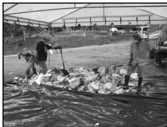
Figura 9: Preparación de la muestra para aplicación del método de cuarteo
